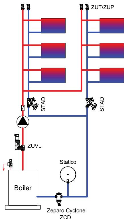
La posizione ideale per l'installazione del separatore di impurità Zeparo Cyclone è sulla tubazione di ritorno, a monte del generatore di calore o in generale dell'unità da proteggere. Non ci sono distanze minime richieste da curve, o altre perturbazioni, a monte o a valle dello Zeparo Cyclone.
